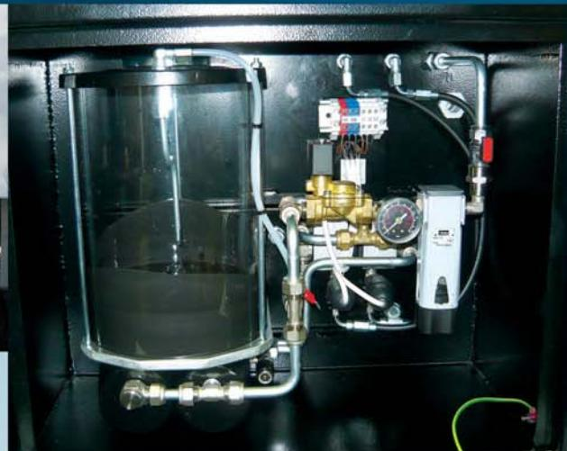
Systém mazání okolků OK-02 je dodáván s otevřenou architekturou řízení systému, ve třech základních úrovních způsobu ovládání a kontroly chodu systému:
